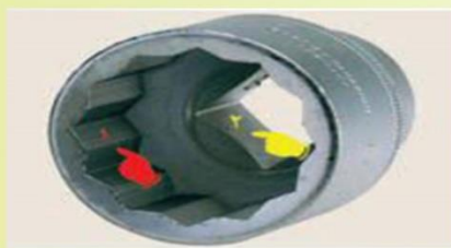
آچار بوکس پایه کوتاه. (۱) سطح شیار، (۲) شکاف مربع شکل
